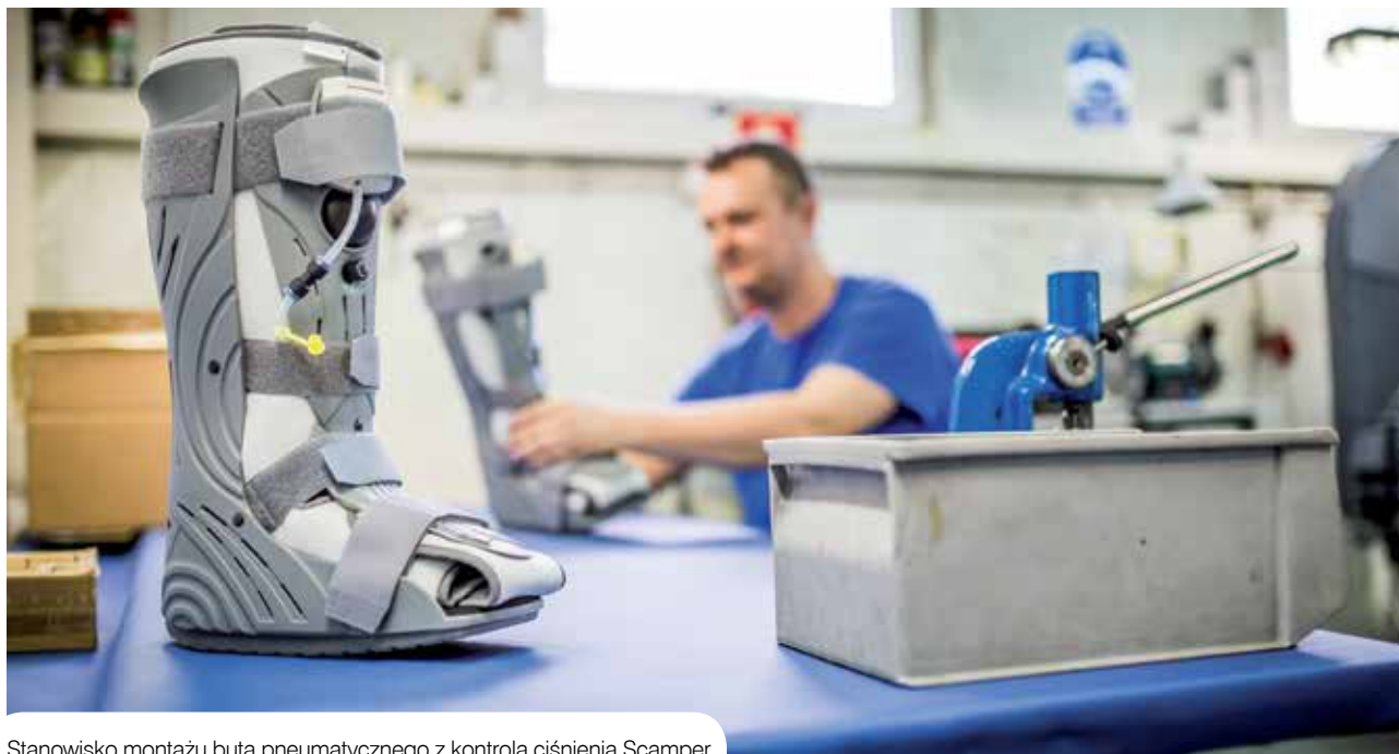
Stanowisko montażu buta pneumatycznego z kontrolą ciśnienia Scamper
